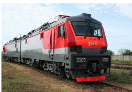
МАГИСТРАЛЬНЫЙ ГРУЗОВОЙ ЭЛЕКТРОВАЗ ПЕРЕМЕННОГО ТОКА 2ЭС5 "СКИФ"
