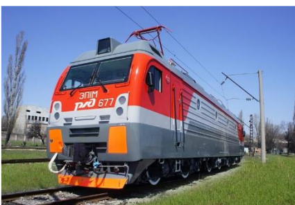
ПАССАЖИРСКИЙ ЭЛЕКТРОВАЗ ПЕРЕМЕННОГО ТОКА ЭП1М
